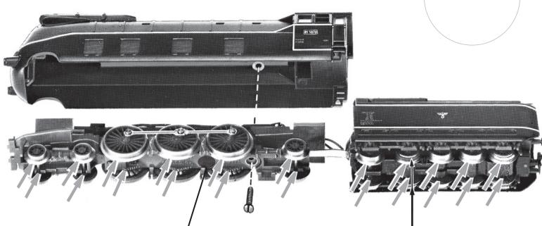
An der markierten Stelle kann der Schaltmagnet 942701 eingebaut werden.
